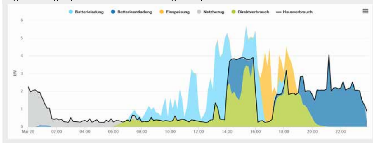
Typischer Tageszyklus einer Photovoltaikanlage mit Speicherbatterie
