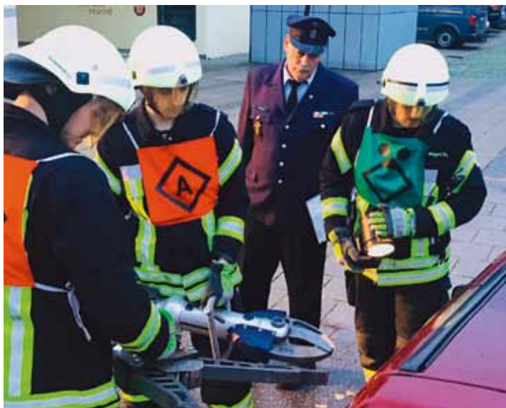
Betrieb des Spreizers und der Rettungsschere
